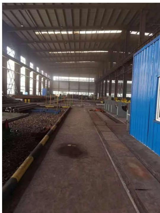
⑥机电公司位于东厂区西侧，占地面积 18799m<sup>2</sup>，主要设备包括带锯机、刨床、搅拌机、压扣机、快速冲电机、带锯机、空压机、退火炉、铣床、轧辊堆焊、铸造炉、容炼设备、离心铸管机、牛头刨床、摇臂钻床、油压机、卷板机、卷扬机、等离子切割机等。
